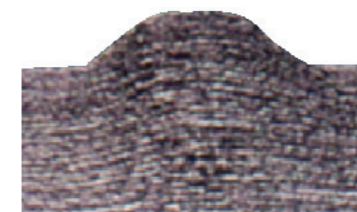
Warmgewalztes Gewinde (SAH) Hot rolled thread
